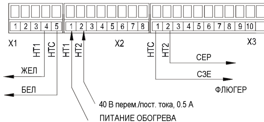
Рисунок 15 Стандартное подключение питания обогрева к обоим датчикам
